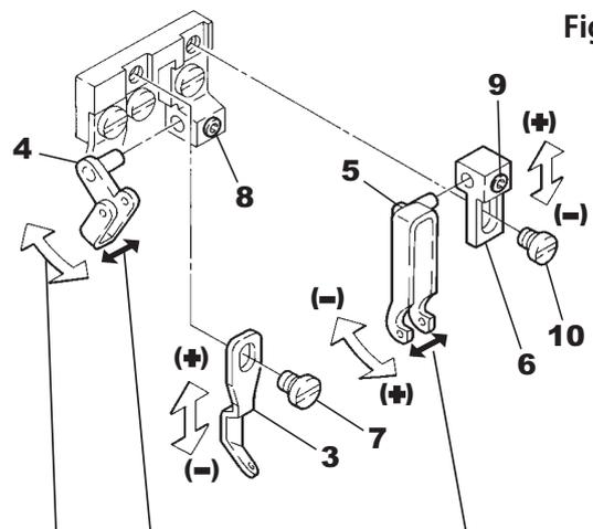
Stellen Sie die Fadenführungen **4** und **5** seitlich so ein, dass sich der Nadelfadengeber mittig zwischen den beiden Zangen der einzelnen Fadenführungen befindet.
