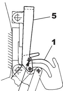
Die Mitte der Öse an der Kante von 1 ausrichten.
