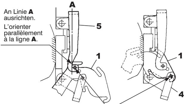
Die Mitte der Öse an der Kante von 1 ausrichten.
