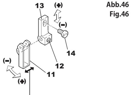
Stellen Sie die Fadenführungen **11** seitlich so ein, dass sich der Nadelfadengeber mittig zwischen den beiden Zangen der einzelnen Fadenführungen befindet.
