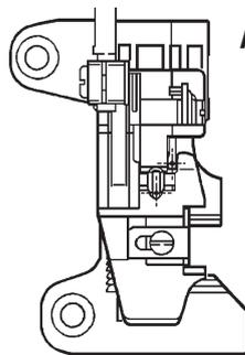
● Avant de faire démarrer la machine, assurez-vous que le pied presseur est bien positionné : tournez le volant lentement à la main pour vérifier que la pointe de l'aiguille pique au milieu du trou d'aiguille dans le pied presseur. (Fig.1)
