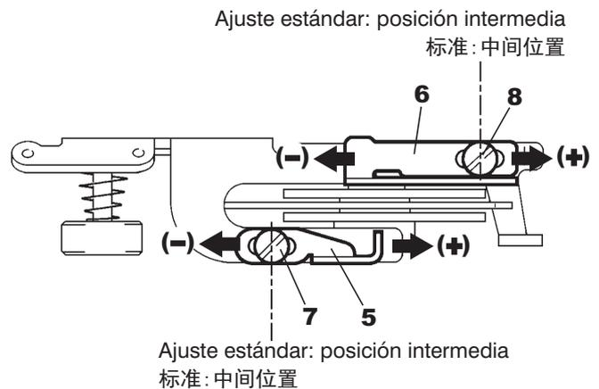
**Posicionamiento del tirahilos del garfio y de las guías de los hilos de los garfios**
