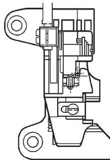
● 在使用缝纫机之前，务必确认压脚是否在正确的位置。（用手轻轻转动手轮，确认针尖是否落在压脚的针孔中心）（图 1）
