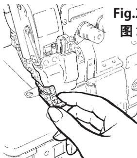
● 务必检查压脚是否牢固的固定好。（使用抬压脚机构抬起压脚，用手前后左右扳动，检查压脚是否有松动）（图 2）
