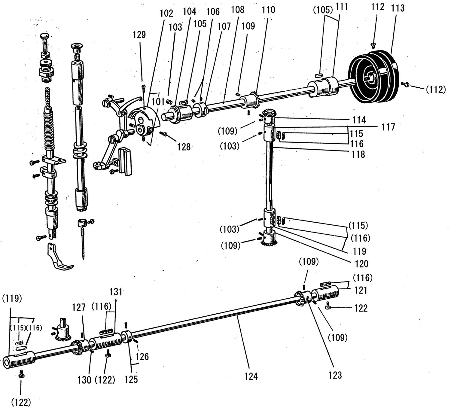
**[B] 上軸・堅軸・下軸部分**
