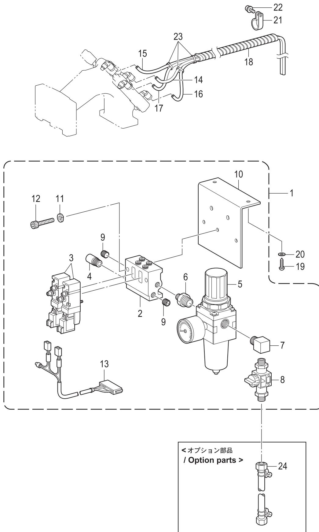
N. 空圧関係 / Air pressure mechanism
