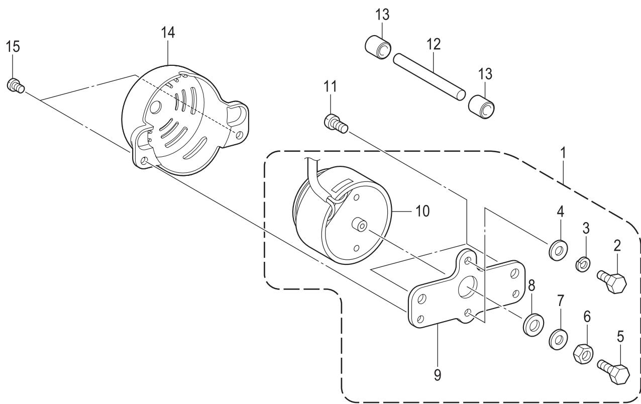
L1. 糸ゆるめ関係(デジタルテンションソレノイド) / Tension release mechanism (Digital tension solenoid)
